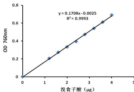
2、总酚 (TP) 含量(mg/g 干重)=( $\Delta A + 0.0025$ ) $\div 0.1708 \times 10^{-3} \div (V1 \div V \times W) \times D$
